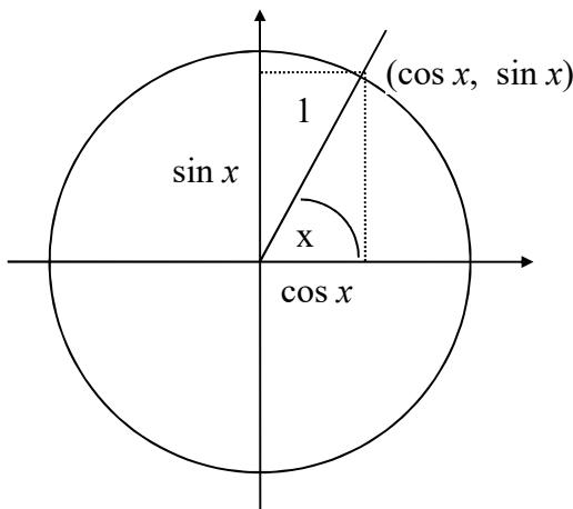
Figuren til venstre viser de grunnleggende definisjonene av de trigonometriske funksjonene.
